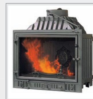
W4 - 12 кВт стекло - прямое вес - 151 кг, Ø 200 мм. ширина - 680 мм высота - 530 мм глубина - 410 мм
